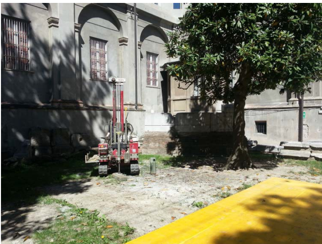
Esecuzione presso i musei civici di prove penetrometriche dinamiche pesanti tipo DPSH ed esecuzione presso il teatro Valli di prova penetrometrica statica tipo CPT con preforo.
