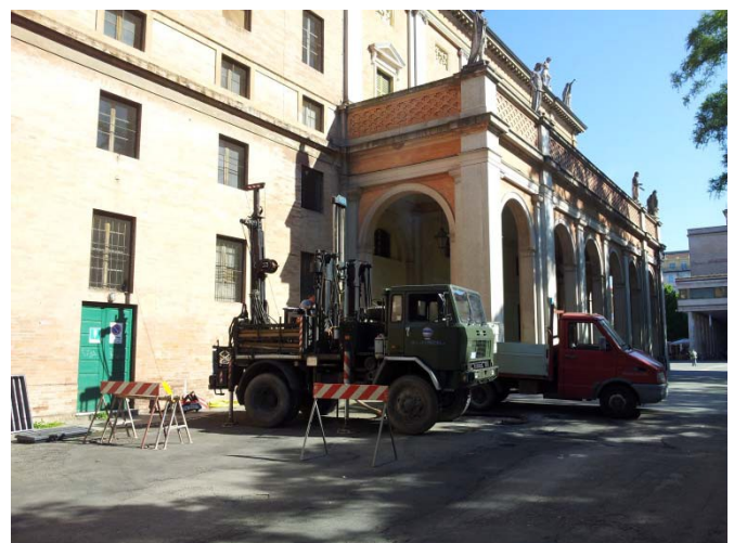
Esecuzione presso i musei civici di prove penetrometriche dinamiche pesanti tipo DPSH ed esecuzione presso il teatro Valli di prova penetrometrica statica tipo CPT con preforo.
