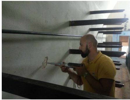
Prova di taglio su murature, prova pacometrica ed esecuzione di martinetto piatto doppio.
