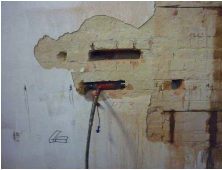
Prova di taglio su murature, prova pacometrica ed esecuzione di martinetto piatto doppio.
