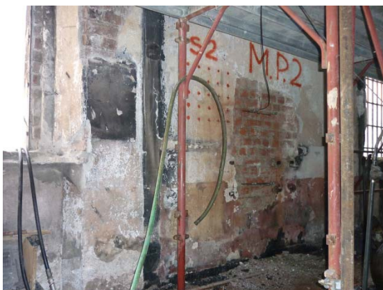
Chiesa parrocchiale di S. Pietro In Sala. Verifica verticalità facciata con stazione totale. Sotto a sinistra esecuzione prova sonica (S2) con relativa elaborazione dati e foto della strumentazione utilizzata.
