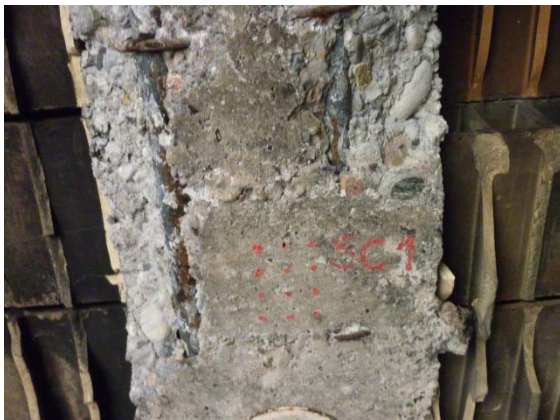
Esecuzione ed elaborazione grafica delle prove sclerometriche (SC1) realizzate su murature.
