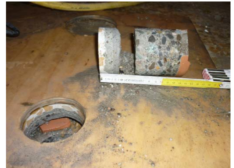
Esecuzione microcarotaggio su solalo con estrazione della carota e relativa descrizione stratigrafica.
