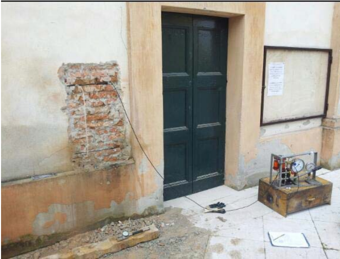
Esecuzione di martinetto piatto doppio su muratura e relativa scheda monografica di elaborazione dati.
