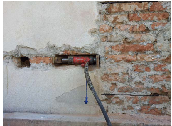
Esecuzione prova di taglio su murature.
