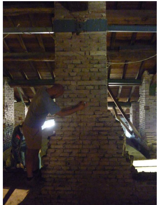
Esecuzione prova di taglio su murature.
