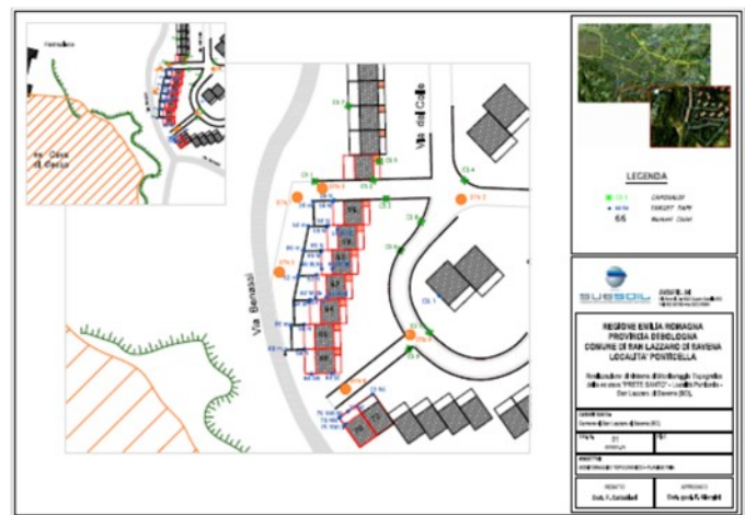
Scheda monografica del rilievo topografico con localizzazione delle mire fisse (capisaldi e punti di monitoraggio).
