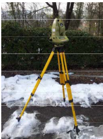
Rilievo celerimetrico con stazione totale di misura Leica TCA1700
