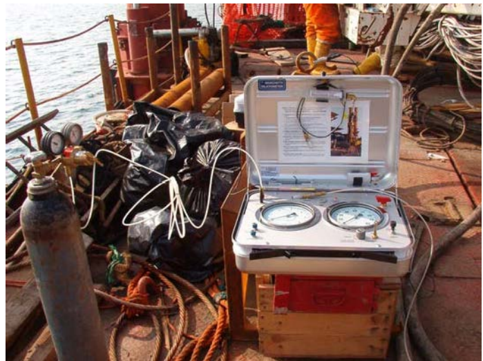
Esecuzione prova dilatometrica con dilatometro Marchetti
