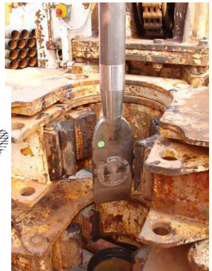
Schema di esecuzione prove dilatometriche. Dettaglio dilatometro Marchetti
