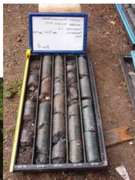
Cassetta catalogatrice e con carote del sondaggio orizzontale
