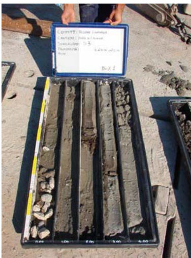
A sinistra fotografia di cassetta catalogatrice con carote del sondaggio a rotazione continua. A destra elaborato grafico rappresentante la stratigrafia dettagliata del sondaggio eseguito.
