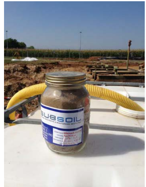
Esempio di analisi granulometrica di campione di terreno (foto sottostante) prelevato da cumulo con metodo della quartatura.
