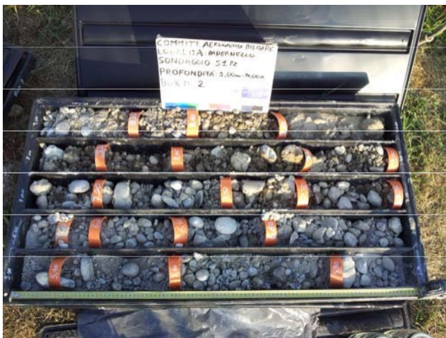
Cassetta catalogatrice per il ricovero dei campioni di terreno estratti e stralcio di stratigrafia
