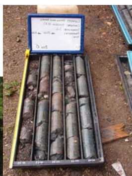
Perforazione a carotaggio continuo orizzontale nella rupe sotto il castello di Rossena
