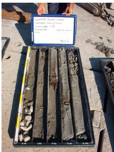
A sinistra fotografia di cassetta catalogatrice con carote del sondaggio a rotazione continua. A destra elaborato grafico rappresentante la stratigrafia dettagliata del sondaggio eseguito.
